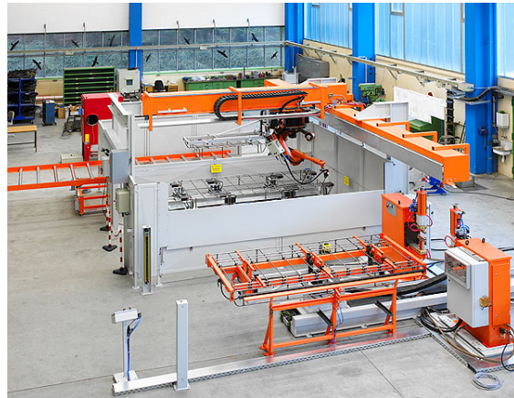
DALEX-kombinierte Widerstands-Roboterschutzgasschweißanlage zum Widerstands- und Schutzgasschweißen von Dachgepäckträgern
