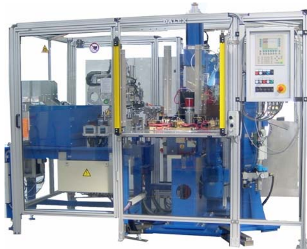
DALEX-6-Stationen-Drehtisch-Buckelschweißanlage zum Buckelschweißen von Schweißmuttern
