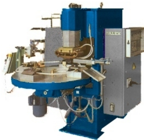
Buckelschweißmaschine PMS 34-4 mit Drehtisch in Viererteilung, Werkzeugsatz, Einlegekontrolle und Entnahmevorrichtung. (Abb. 2)
