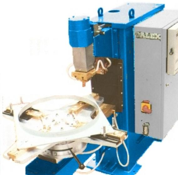
Buckelschweißmaschine PMS 11-4 mit handbetätigtem Drehtisch und eingelegtem Bauteil (Abb.2)
