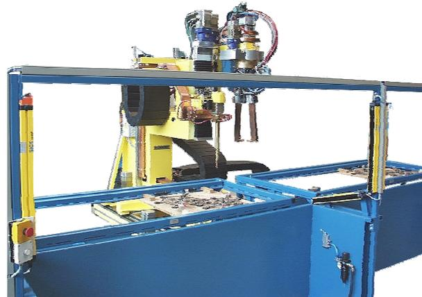
DALEX-Mittelfrequenz-CNC-Koordinaten-Schweißanlage zum Schweißen von Drahtkörben
