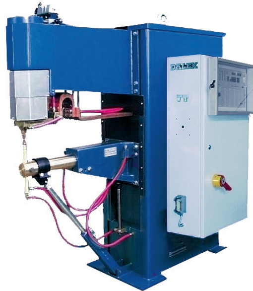
Abb. PMS 16-4 in der Ausführung A als Punktschweißmaschine
