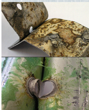
② DEMONSTRACNÍ SVÁR - PLECH S POZŮSTATKY LEPIDEL
