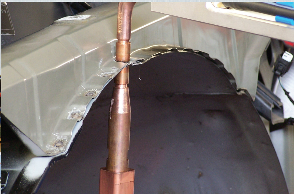
STANICE PRO DOVAŘOVACÍ PRÁCE - ROBOTOVÁ LINKA
