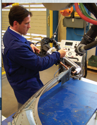
STANICE PRO DOVAŘOVACÍ PRÁCE - ROBOTOVÁ LINKA
