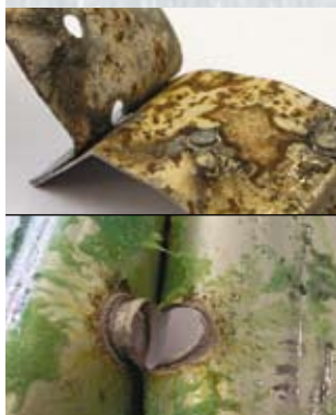
② DEMONSTRACNÍ SVÁR - PLECH S POZŮSTATKY LEPIDEL
