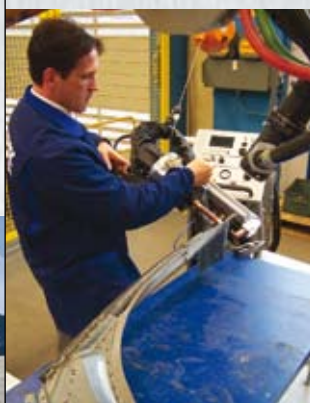
STANICE PRO DOVAŘOVACÍ PRÁCE - ROBOTOVÁ LINKA
