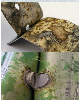
② DEMONSTRACNÍ SVÁR - PLECH S POZŮSTATKY LEPIDEL
