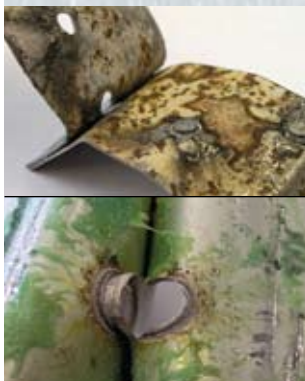
② DEMONSTRACNÍ SVÁR - PLECH S POZŮSTATKY LEPIDEL
