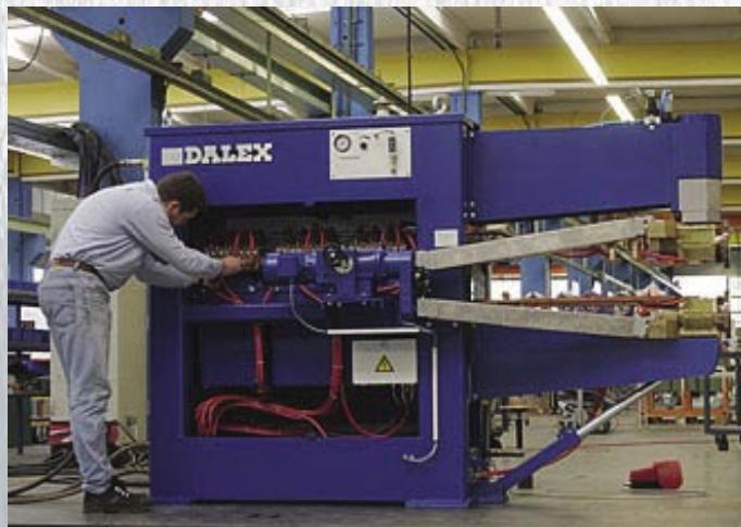
DALEX třífázový stejnosměrný odpornový svařovací lis
